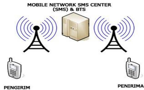
Gambar.6. Skema sederhana cara kerja SMS [4].
